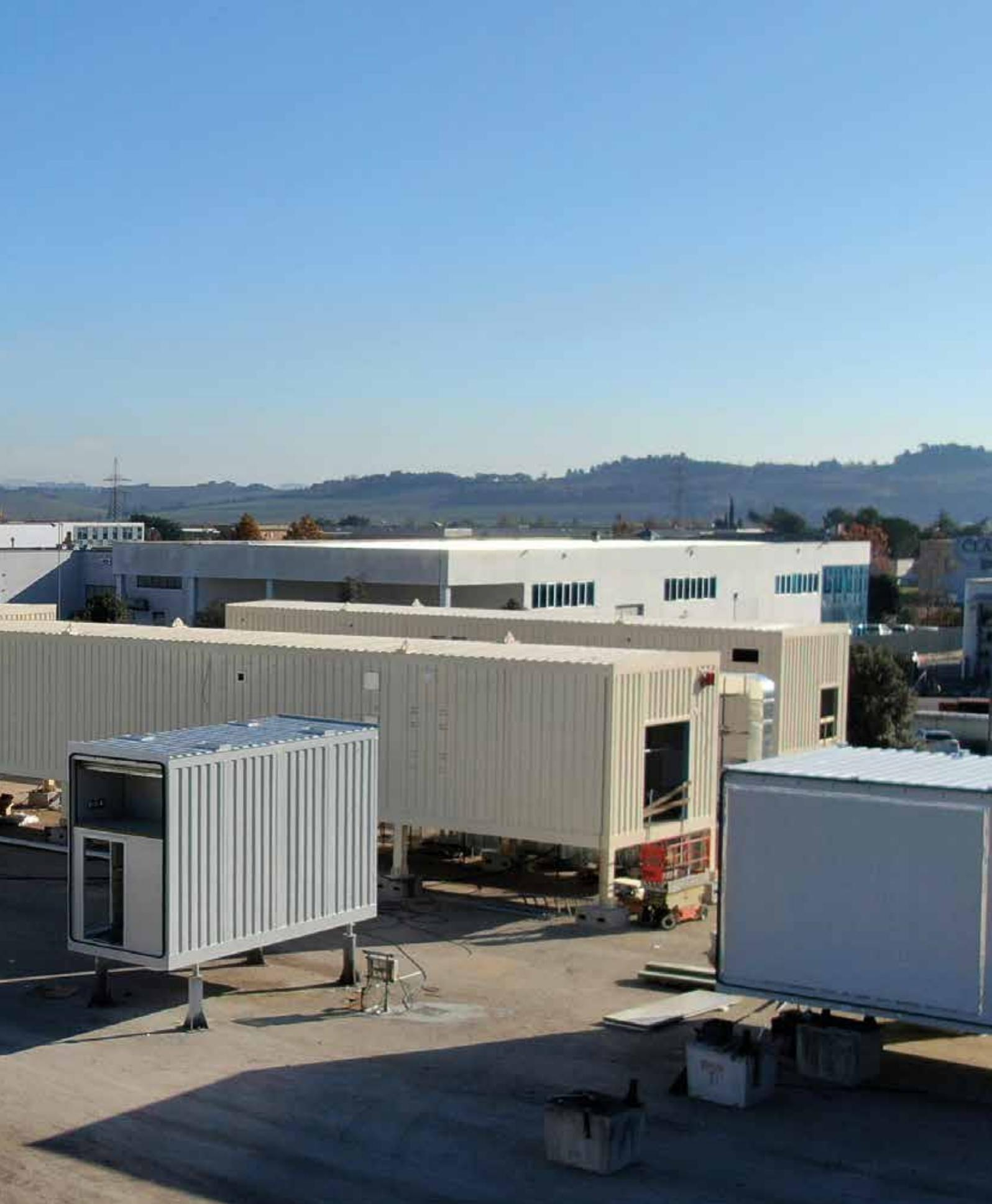
Stazioni containerizzate in lavorazione nel nuovo stabilimento di Jesi. Imesa è in grado di realizzare singoli moduli di notevoli dimensioni (fino a 26mt di lunghezza x 6mt di larghezza x 6mt di altezza) / **Containerised stations in production in the new Jesi plant. Imesa can build large containers (up to 26 m long x 6 m wide and 6 m high)**
