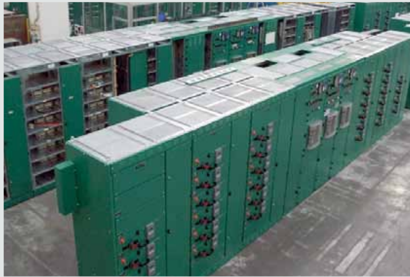
Quadri elettrici Power/Motor control center con caratteristiche elettriche 400V-1000A-50kA, dotato di cassette estraibili, per il controllo delle utenze ausiliarie dei Compressori Dresser
