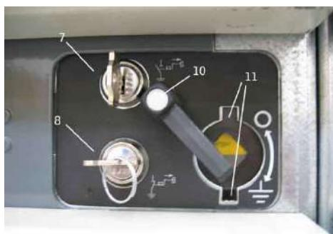
*Fig. 58 – Manovra del sezionatore di terra*
